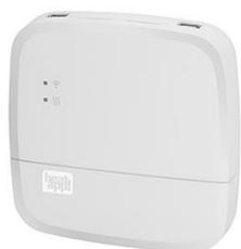
Интеграционный контроллер **heatapp!Base OT** – центральный компонент дистанционной системы управления может быть сопряжен генераторами тепла по протоколу OpenTherm, через выход 0...10В или реле типа «сухой контакт» (SPST).
