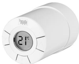
Привод радиаторного клапана **heatapp! drive** предназначен для управления температурой в отдельном помещении путем регулирования протока теплоносителя через радиаторный клапан. Привод имеет встроенный датчик температуры воздуха в помещении.
