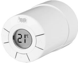
Привод радиаторного клапана **heatapp! drive** предназначен для управления температурой в отдельном помещении путем регулирования потока теплоносителя через радиаторный клапан. Привод имеет встроенный датчик температуры воздуха в помещении.
