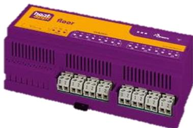
**heatapp! floor** - это контроллер управления термоэлектрическими приводами, установленными на коллекторе теплого пола и/или радиаторного контура. Можно управлять до восьми каналов, каждый с тремя термоэлектрическими приводами. В сумме, можно подключить до 24 термоэлектрических приводов на один *heatapp! floor*.
