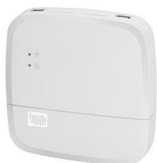
Интеграционный контроллер **heatapp!Base T2B** – центральный компонент дистанционной системы управления может быть сопряжен с контроллерами THETA, генераторами тепла через выход 0...10В или реле типа «сухой контакт» (SPST). Подключение *heatapp! Base* к контроллеру THETA осуществляется через шину T2B.
