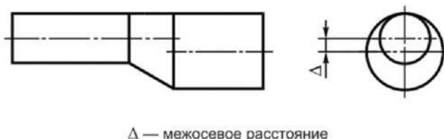
Рисунок 6.1 - Устройство несоосного перехода труб
