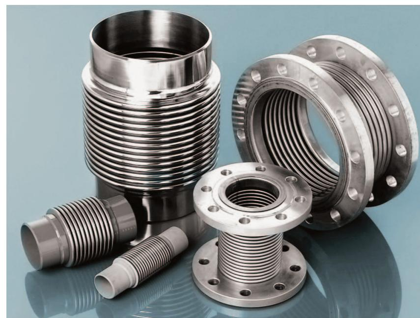
Оевые сильфонные компенсаторы применяются в качестве компенсирующих монтажных элементов для поглощения температурных деформаций трубопроводов вдоль своей оси, транспортирующих горячие и холодные теплоносители, подвижных вводов в напорных резервуарах и т.д. На рисунке показан односекционный компенсатор с компенсирующей способностью 25, 35, 50, 80 мм и двухсекционный с 50, 70, 100, 160 мм.
