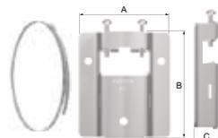
Для монтажа баков Flexcon/Airfix емкостью 8–25 литров.
