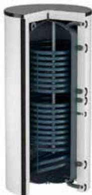
Высокоэффективный водонагреватель для гелиотермических установок. Оснащается двумя теплообменниками для обеспечения возможности одновременного применения в различных системах отопления, например, с газовым котлом и солнечными коллекторами. Предназначен для снабжения горячей санитарной водой больших жилых домов, коммерческих и промышленных объектов.
