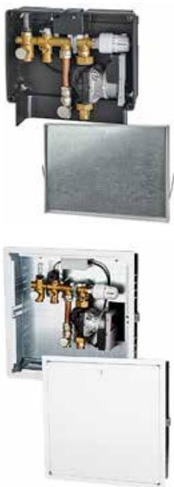
Универсальный регулировочный короб Komfort Plus предназначен для организации низкотемпературного контура теплого пола в рамках с классической радиаторной системы отопления. Короб может комбинироваться с комнатным термостатом 230 В, что позволяет максимально комфортно и эффективно регулировать отопление. Циркуляционный насос уже входит в комплект короба, что позволяет применять его для помещений до 40 м<sup>2</sup>.
