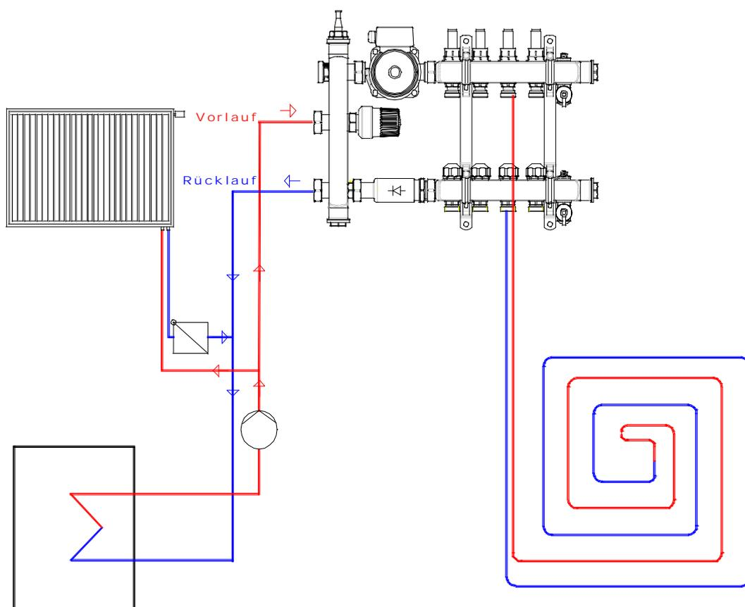
За счёт контролируемого добавления котловой воды из контура радиаторного отопления (напр. 70°C) и смешивания её с водой из обратного коллектора тёплых полов, понижается температура подачи до установленной температуры (напр. 40°C). Здесь применяется гидравлическая схема с подмешивающим включением. Требуемая температура подачи устанавливается термостатической головкой. Температура котловой воды должна на 10-15°C превышать желаемую температуру подачи тёплого пола.
